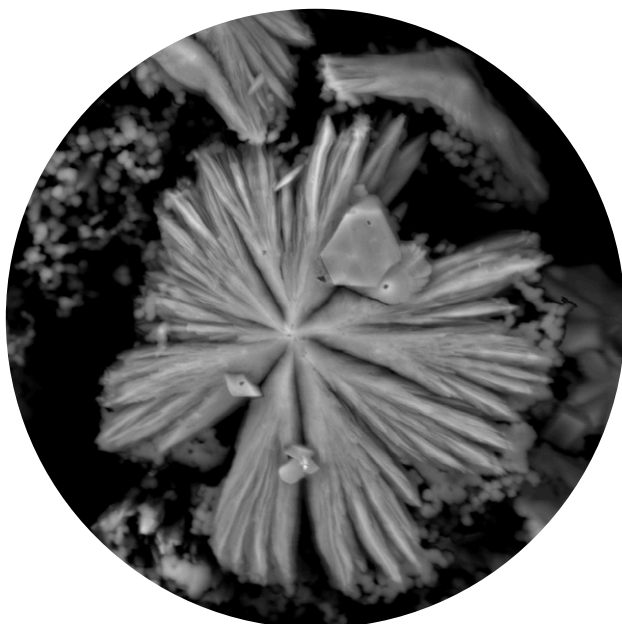
Ubehandlet kalk: nåleformede, sammenvoksede dendritter, der hæfter til overflader.
