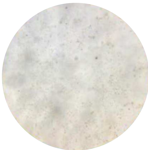
LAGUR-behandlet vandprøve: blødere, fint omformet materiale.
